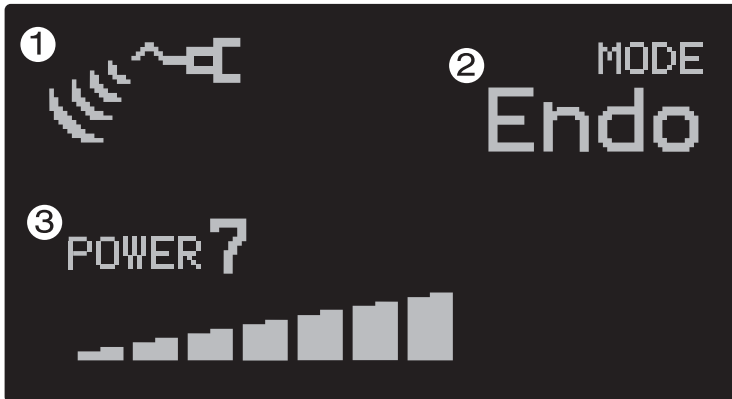
Fig.2 Affichage normal lors de l'utilisation du démarreur.
